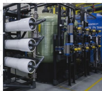
DESALADORA DE AGUA DE MAR CON TURBINA DE AHORRO DE ENERGÍA 3400GPM A 30 000 PPM
